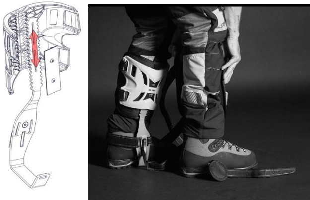
Rysunek 2. Regulacja wysokości poduchy
