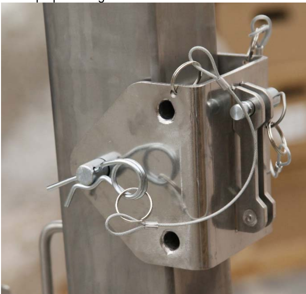
Rysunek 10 - Uniwersalny uchwyt do wciągarek PSD100-131-000 zamocowany na słupie pionowym.
